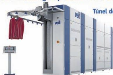
Túnel de planchado / acabados
